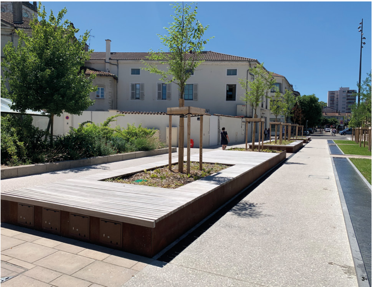
1- Paris (75) | Aluminium thermolaqué grainé (sablé) | Costière sur mesure avec assise en bois exotique - Sanded (grooved) hot lacquered aluminium | Specific kerb with exotic wood slats · 2- Sanem (Luxembourg) | Acier corten sablé, activé et stabilisé | Costière sur mesure avec assise en bois exotique - Sanded, activated and stabilized corten steel | Specific kerb with exotic wood slats · 3- Bourg-en-Bresse (01) | Acier corten sablé (livré non activé) | Costière sur mesure, assise en bois exotique - Sanded corten steel (delivered non activated) | Specific kerb, slats in exotic wood
